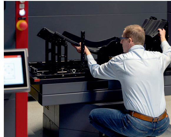
Bild 1. Das von Andre Gromann entwickelte Vorrichtungskonzept in der ScanBox ermöglicht die gleichzeitige Messung mehrerer Bauteile. © GOM Metrology GmbH
